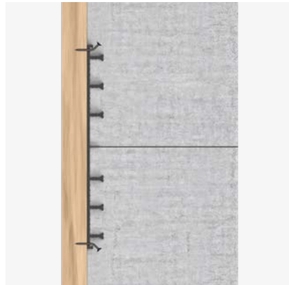
Arbeitsfuge Wand-Wand: Befestigung an der Schalung.
