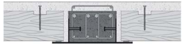
Holz-Beton-Verbunddecken (Ortbeton). Brettschichtholzplatten.
