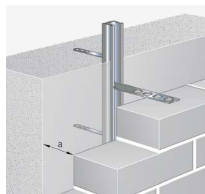
Anschluss von Verblendschalen an Stahlbetonbauteile mit Maueranschlusschiene Kt 28/15-D und -anker
